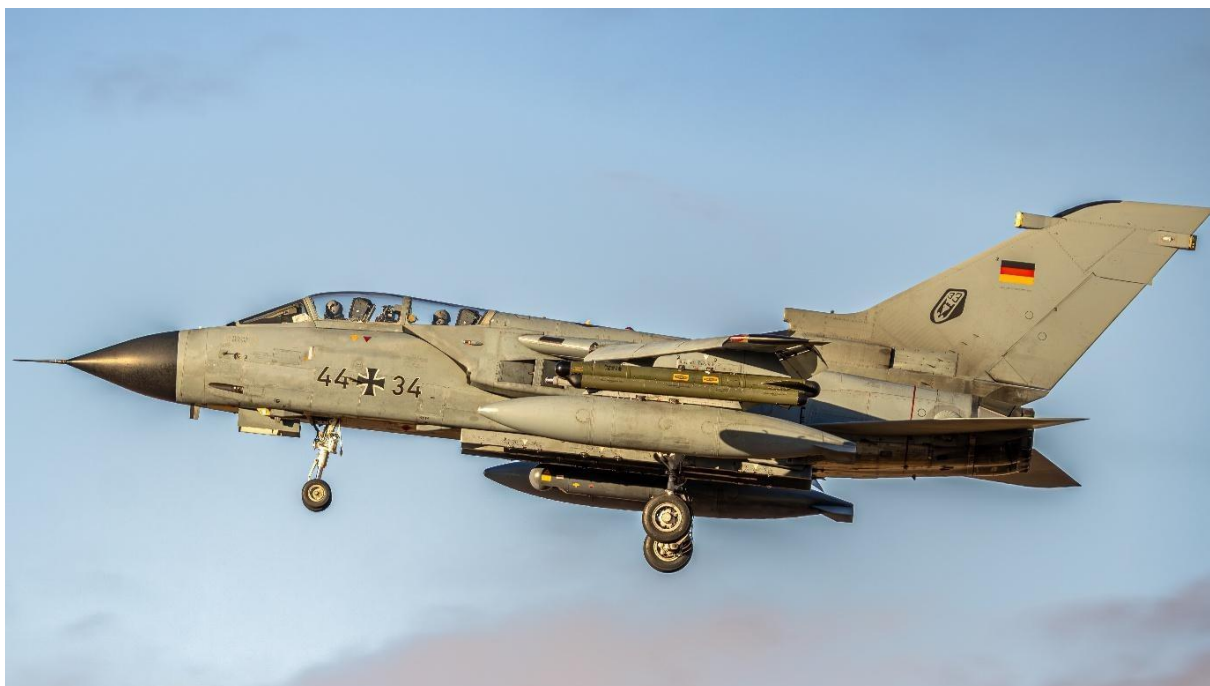
Tornado IDS 44+34 en configuración de aterrizaje. Nótese en primer plano bajo el ala izquierda, el TSPJ (Cerberus). En el pílón central se puede observar el designador laser AN/AAQ-28(V) LITENING. Foto: Pablo Carrillo.
