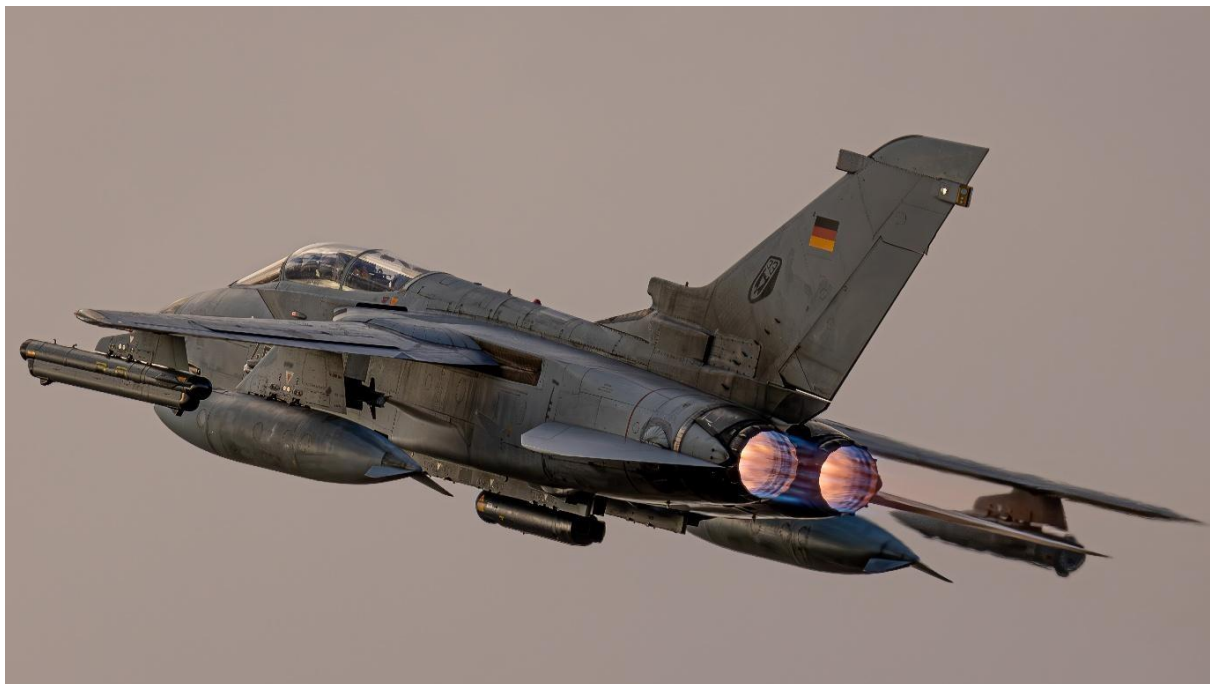
Post-combustión On. Foto: Pablo Carrillo .
