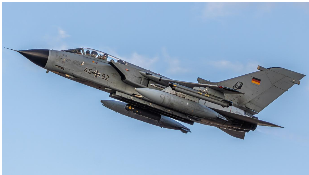
Tornado IDS 45+92. Nótese en primer plano bajo el ala izquierda, el TSPJ (Cerberus). En el pilón central se puede observar el designador laser AN/AAQ-28(V) LITENING y los dos depósitos auxiliares de combustible. Foto: Pablo Carrillo .
